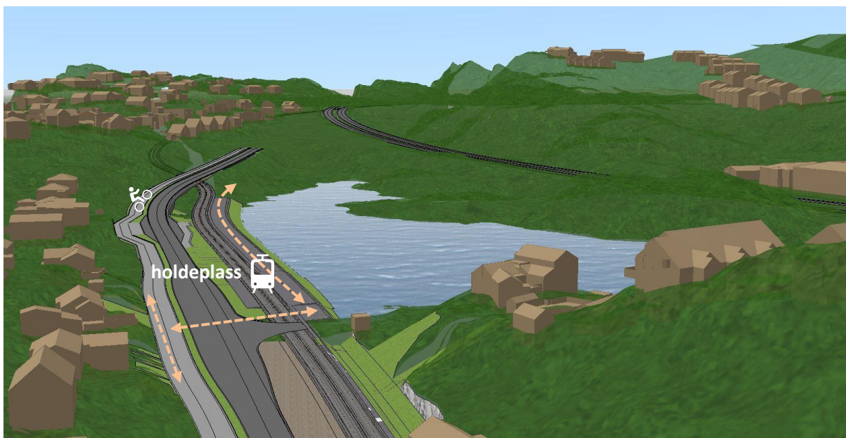
Figur 11: Arbeidsmodellen viser plassering av holdeplass i Ervikveien ved Griggastemma i anbefalt alternativ, sett mot nord. Fremtidig tursti langs Griggastemma er vist som grå flate på utsiden av banetraseen. Gangkoblinger vist med stiplet linje.
